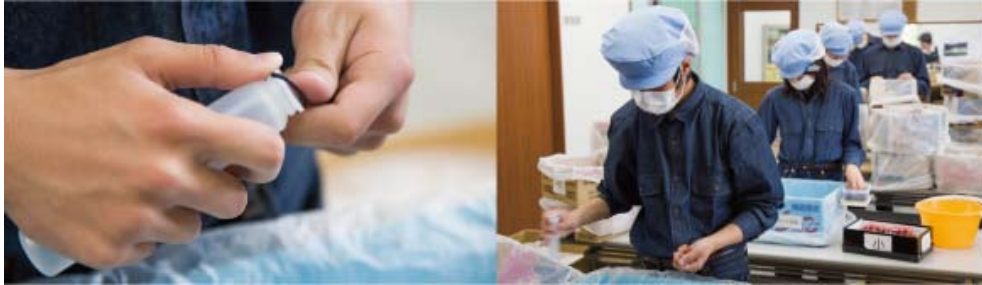
Oリングの組み付け作業
