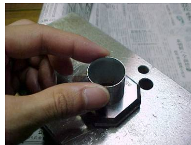
←ゲージを製品が通るかを確認します。 OKのものは、下の箱へ入るようにセットしてあります。 ※撮影のため見やすいように軍手ははずしています。
